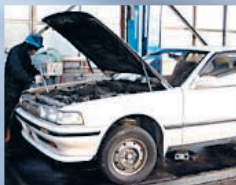
フロン回収作業
