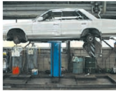
油抜き取り作業
